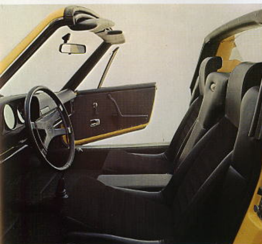
Les sièges avec leur dessin enveloppant (appuie-tête incorporé et forts rembourrages latéraux) sont situés dans la partie qui bénéficie le mieux de la bonne suspension : au centre entre les deux essieux.
