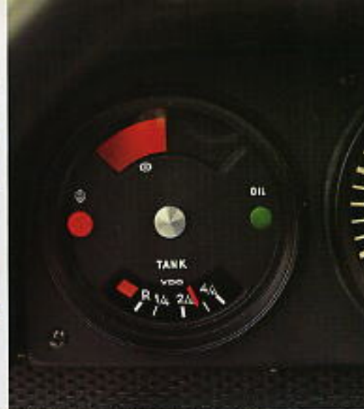
Cadran groupant : le thermomètre, la jauge à essence et le manomètre d'huile, de même que le témoin pour le frein à main serré.
