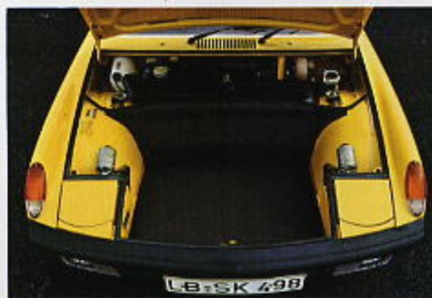
La VW-Porsche 914 est la seule deux places avec un volume à bagages pour 4 : à l'av. 160 litres, à l'arr. 210.
