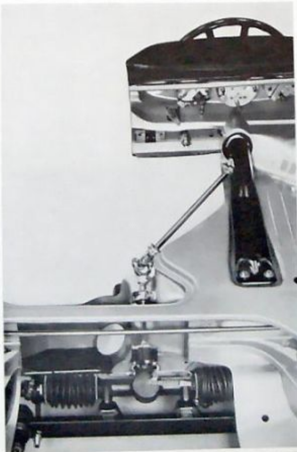
Sicherheitslenkung: Dreigeteilte Lenktrahle, wartungslose Kreuzgelenke.
