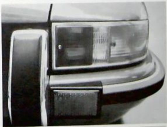
Halogen-Hauptscheinwerfer, Blinkleuchte, Nebellichter. Rückleuchte, Rückfahrscheinwerfer, Blinkleuchte und Rückstrahler.
